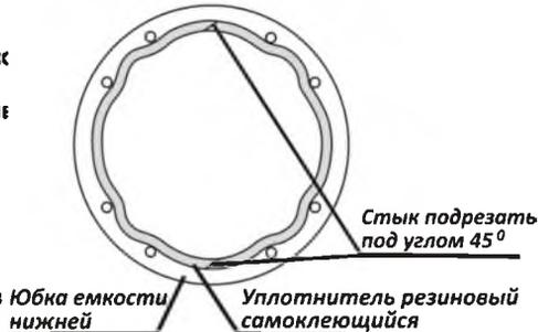
3.9. Установить, собранную в п.п. 3.8 ёмкость на узел собранный в п.п. 3.1 – 3.7 и прикрепить её к скобе (4) используя шайбы регулировочные (14), шайбы (27,29) и болт (22). При этом, изменяя толщину пакета шайб
