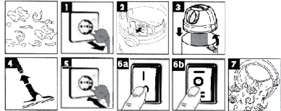
قبل از تعویض فیلتر یا کیسه دستگاه را از پریز بکشید(شکل1)، سپس کیسه را خالی یا جایگزین کنید. کیسه گرد و خاک را برای خشک کردن جاروبرقی روی سوکت بکشید(شکل2).
