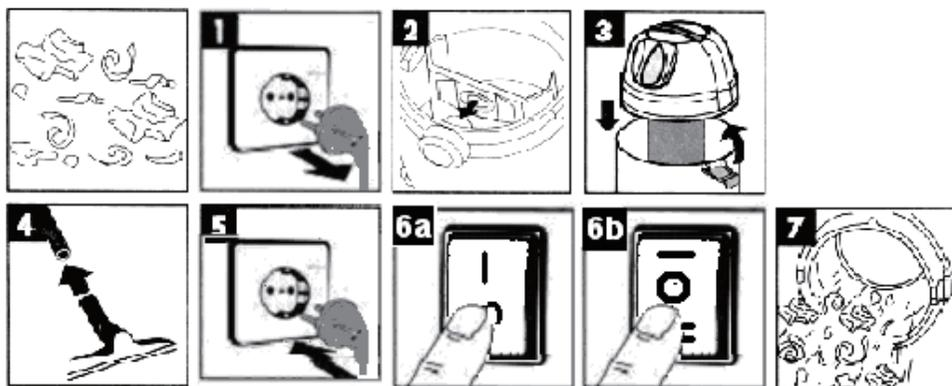
Перед заменой фильтра или пылесборника удалите штепсель из розетки (Рисунок 1), затем выньте мешок и удалите пыль или замените сумку. Наденьте мешок для пыли на розетку (рис. 2) для сухой уборки пылесосом.
