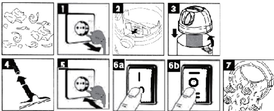
Desenchufe antes de cambiar el filtro o la bolsa de partición de polvo (Figura 1), luego saque la bolsa y vacíe el polvo o reemplace la bolsa. Deslice la bolsa de polvo en la toma (figura 2) para la limpieza al vacío en seco.
