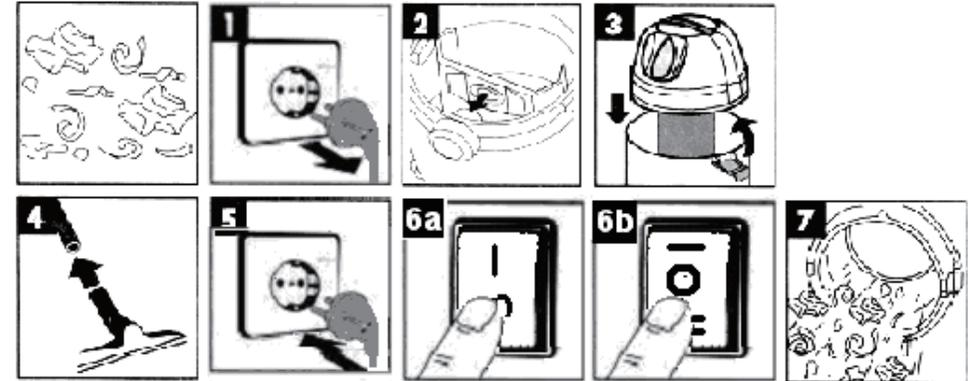
افصل قبل تغيير فلتر (الشكل 1)، ثم أخرج الكيس وتفريغ الغبار أو استبدال الكيس. اسحب حقيبة تقسيم الغبار فوق سلة الفلتر (الشكل 2) للتنظيف بالمكنسة الكهربائية الجافة.
